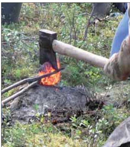
Fig. 10. Jernsvampen er netop taget ud af ovnen og kløves med en økse
