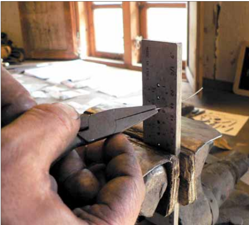
Fig. 15. Trækning af tråd af rent jern til ringe i ringbrynje
