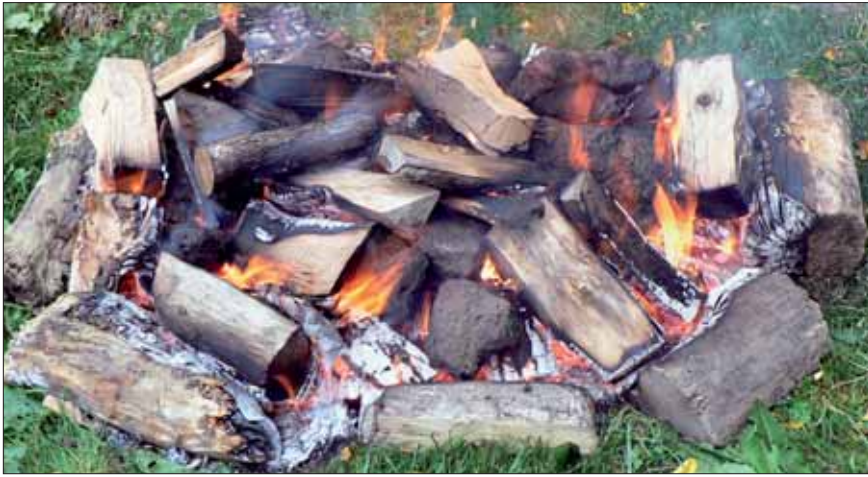
Fig. 5. Myremalmen ligger på ristningsbålet, hvor den forberedes til jernudvinding i ovnen
