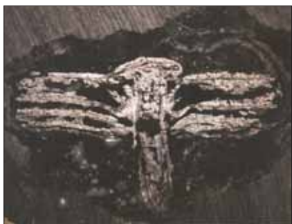
Fig. 1. Tværsnit af myremalmsjern. Søm slået gennem plade. Foto: Robert Thomsen's arkiv, Museet for Varde By og Omegn
