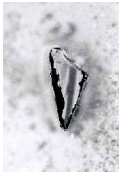
Fig. 12. Tværsnit af kniv fra vikingetiden der er smedet af tre stykker jern. Et stykke kulstofjern mellem to stykker rent jern
