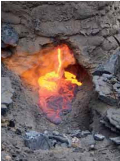
Fig. 9. Slaggen løber fra det faste jern
